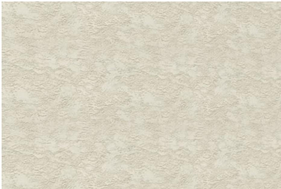
Plâtre au ciment utilisé comme fini de surface d'un mur extérieur et généralement appliqué à un lattis métallique fixé à une base de mur. Le plâtre est composé de ciment Portland, de chaux, de sable et d'eau. Convient à des éléments de murs extérieurs tels que de nombreuses ouvertures et formes de coins, fenêtres et portes, typiques des maisons haut de gamme.
