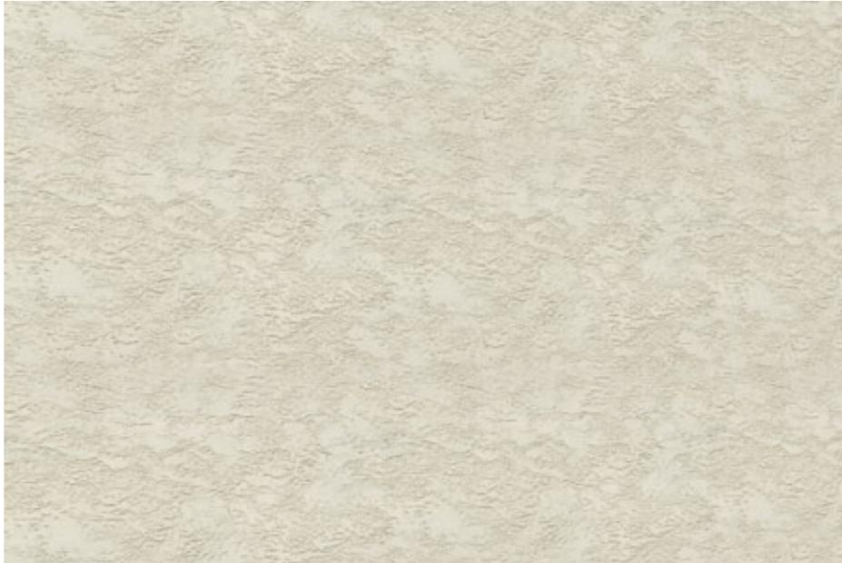
Plâtre au ciment utilisé comme fini de surface d'un mur extérieur et généralement appliqué sur une base de bloc de béton. Le plâtre est composé de ciment Portland, de chaux, de sable et d'eau. Convient à des éléments de murs extérieurs tels que de nombreuses ouvertures et formes de coins, fenêtres et portes, typiques des maisons haut de gamme.
